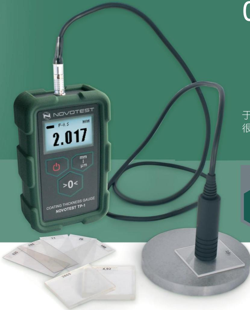
便携式涂层测厚仪 NOVOTEST TP-1M 用于对涂层厚度进行无损检测的设备，具有很高的测量精度。
